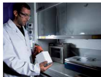
Des cabines feu permettant de mesurer l'allumabilité et la vitesse de combustion.
