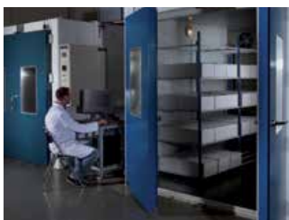
Des enceintes climatiques et logiciels de simulation numérique permettant de tester la tenue en température des solutions isothermes.
