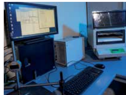
Un équipement de mesure de la conductivité thermique.
