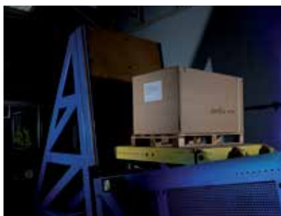
Un plan incliné et une table vibrante permettant la simulation de transport et de chute (drop test).
