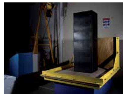
Un plan incliné et une table vibrante permettant la simulation de transport et de chute (drop test).
