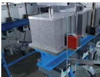
Des bancs de fluage permettant de mesurer l'écrasement à long terme.
