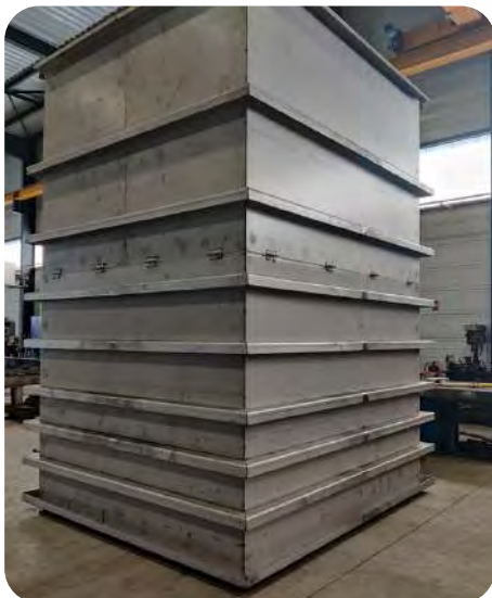
Fabrication d'une cuve Inox 316L
