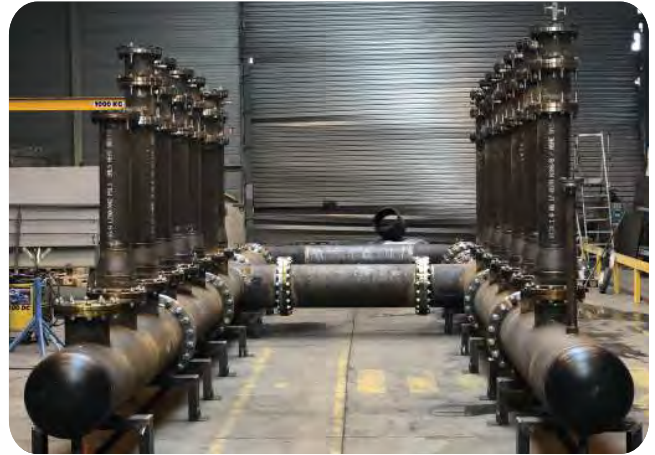
Réalisation d'une tuyauterie DN 500
