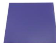
Transition réversible bleu \rightarrow incolore T^\circ = 35^\circ\text{C}
