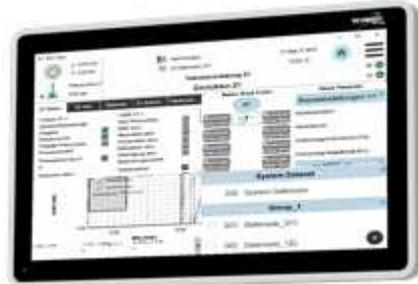
Les nouvelles commandes PRC 700 et PRC 7000 équipent désormais toutes les presses avec contrôle force/course. Elles sont plus compactes, disposent de fonctions étendues et d'un écran tactile plus grand. De nombreuses fonctions issues de la manipulation sur tablettes ont été reprises pour le paramétrage et la visualisation des process.
